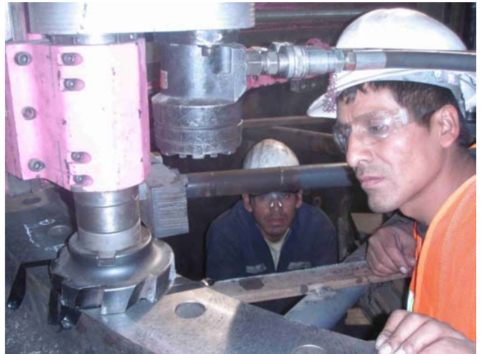
Fuente: P5223016.JPG Detalle del fresado con cabezal CLIMAX PM5000
