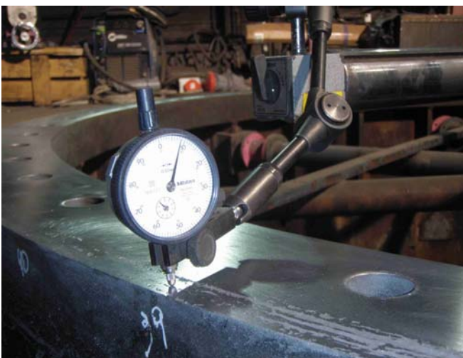
Fuente: P5233039.JPG Revisión de la planitud
