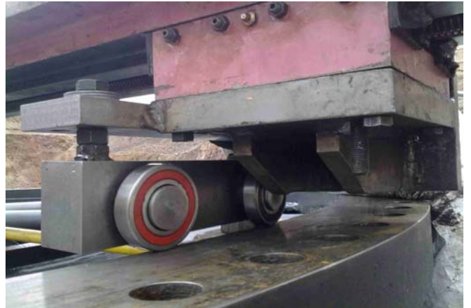
Fuente: 13032010875.JPG Detalle patín (Soporte auxiliar)
