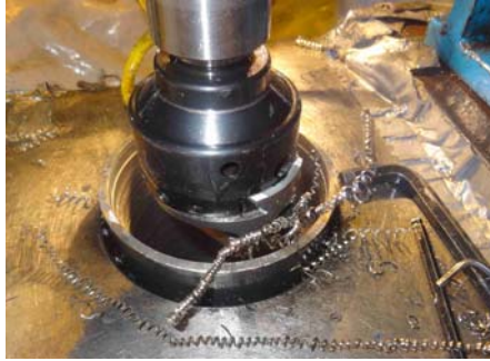
Fuente: DSC00822.JPG Barrenado (hasta 4. 3/4 “)
