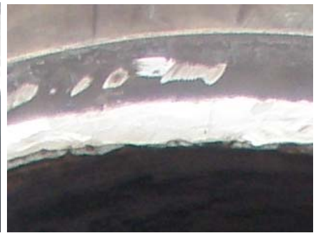
Detalle relleno de soldadura Fuente: P6230305.JPG
