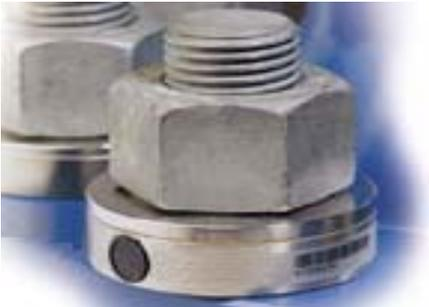
Esta celda de carga se incorpora -como una arandela normal- en la unión roscada. Al ajustar el perno, nos indicará en un display externo la fuerza de apriete que se está generando – independientemente del método usado.
