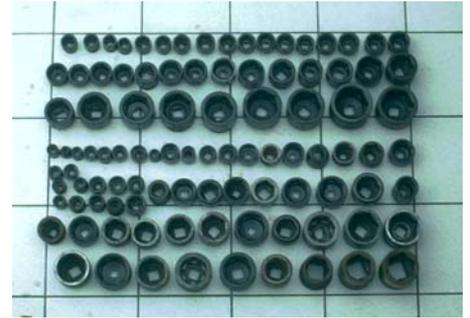
Tenemos 180 llaves con encastres desde  $\frac{3}{4}$  hasta 2.½ " y sus dados, con capacidades de torque de 60 hasta 28,002 libras pié (81 Nm hasta 37,943 Nm), además de 21 llaves con cabezales hexagonales (de 1.  $\frac{1}{16}$ " hasta 6.  $\frac{1}{8}$ " ) intercambiables – para las aplicaciones donde la altura de la llave y/o el peso es crítico – así como los multiplicadores de torque manuales. Las llaves pueden ser suministradas con personal calificado para que las operen.
