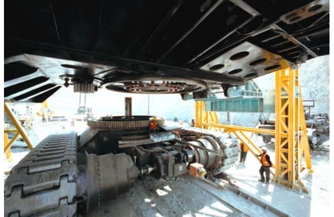
Fuente: 047.JPG Carbody (abajo) y revolving frame (arriba)
