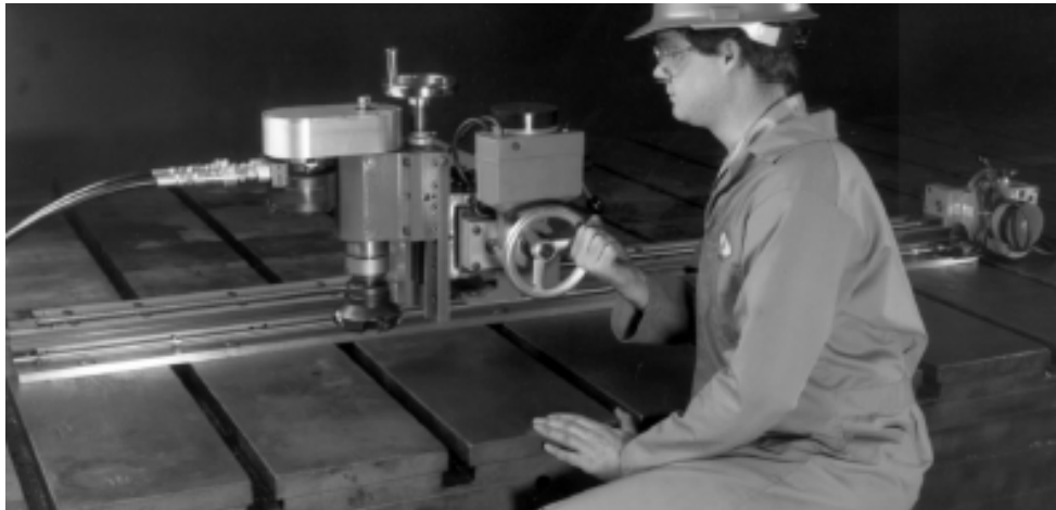
Foto: Maquinado de una superficie, con una mesa base de 96" (2,438.4 mm)
