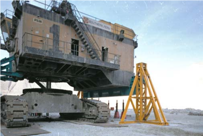
Fuente: 032.JPG Sistema de izaje SYNCHROLIFT™ (SPCC)
