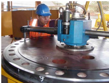
Fuente: P2180217 Centrado y maquinado de la tapa
