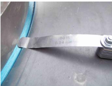
Fuente: P3070421 No entra el gauge de 0.04 mm
