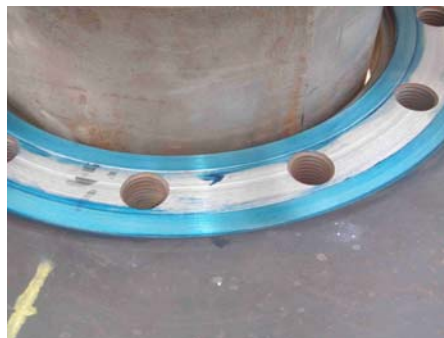
Fuente: P3070416 Prueba con azul de Prusia
