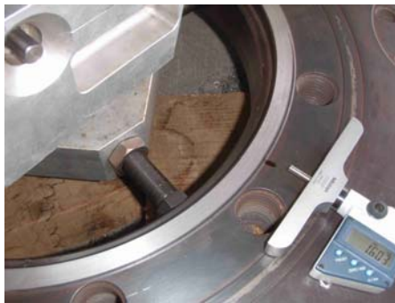
Fuente: P3070408 Superficie de sellado completa, habiéndose maquinado 1.60 mm ...
