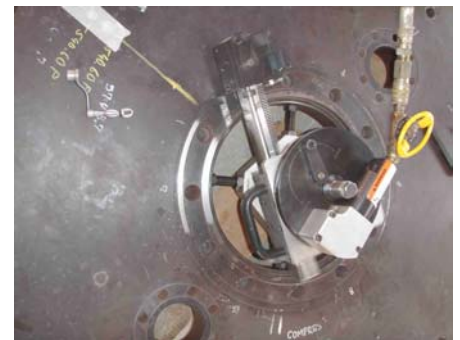
Fuente: P3070367 Maquinando las partes altas ...
