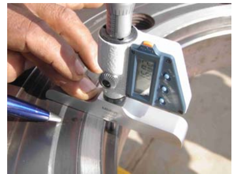
Fuente: P3070408 Superficie de sellado completa, habiéndose maquinado 1.60 mm ...
