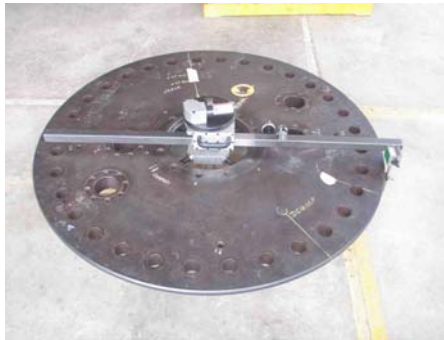
Fuente: P3050335 Nivelado (paralelo a sello inferior)
