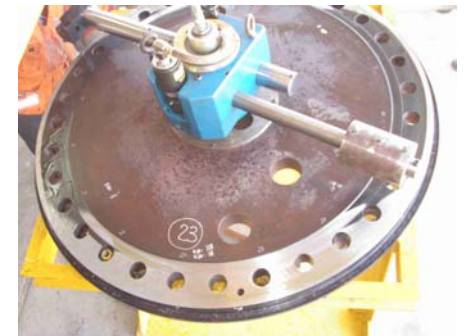
Fuente: P2180252 Maquinado área de sellado externa
