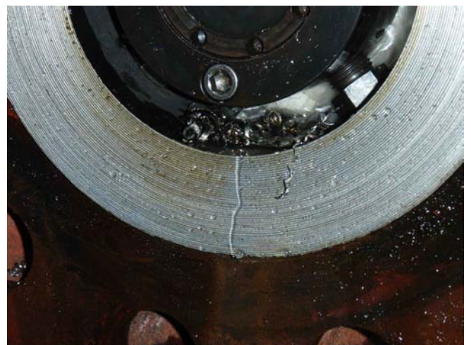
Fuente: PC140918.JPG Superficie de sellado, luego de la última pasada
