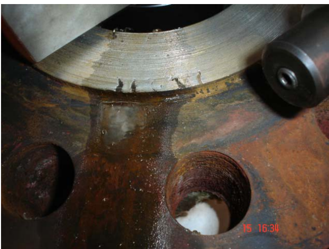
Fuente: DSC03397.JPG Superficie de sellado, luego de la primer pasada
