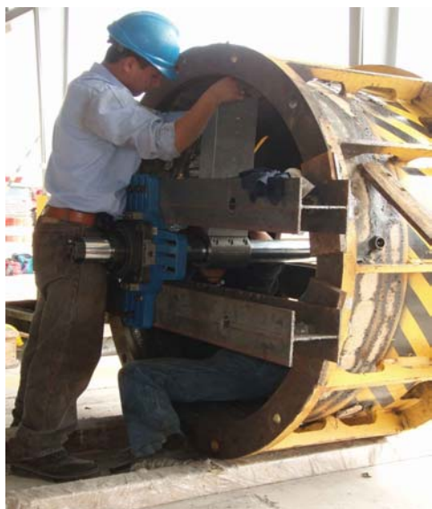
Fuente: P1311766.JPG Centrando la barrenadora
