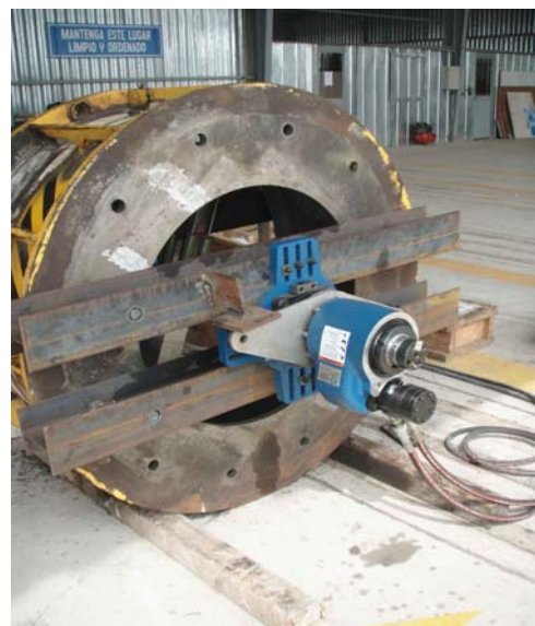
Fuente: P2021854 .JPG Lado motriz, con motor hidráulico
