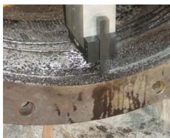
Fuente: P1311813 y 14.JPG Maquinando la superficie
